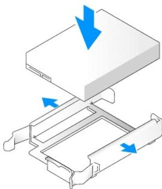
5. Spostare il primo disco rigido dall'alloggiamento superiore a quello inferiore:
