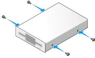
3. Allineare le viti a testa cilindrica con esagono incassato sull'unità disco floppy con gli slot delle viti a testa cilindrica con esagono incassato, quindi far scorrere delicatamente l'unità nell'alloggiamento finché non scatta in posizione.
