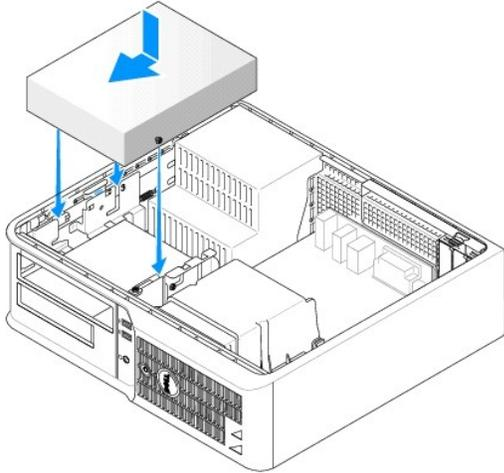
6. Controllare tutti i collegamenti dei cavi e raggruppare tutti i cavi in modo che non ostruiscano il flusso d'aria alla ventola e alle prese di raffreddamento.
